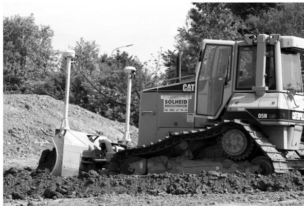
Figure 7. Bulldozer piloté par GPS
